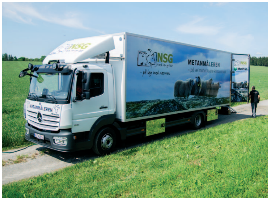
TILPASSET NORSK KLIMA: Lastebilen Metanmåleren har 10 klimakamre, og er bygget for å passe norsk geografi, klima og vegstandard. Foto: Aurora Hannisdal, Differ Media
