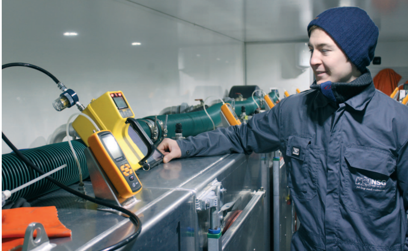
METANTEKNIKER: Martin Opheim Gløersen, nyansatt rådgiver for saueavl i NSG, måler konsentrasjonen av gassene i klimakammeret. Foto: Lars Erik Wallin
